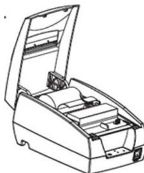
Para instalar uma nova fita na impressora conforme ao lado, gire o botão da fita aproximadamente 5-6 voltas no sentido horário,
